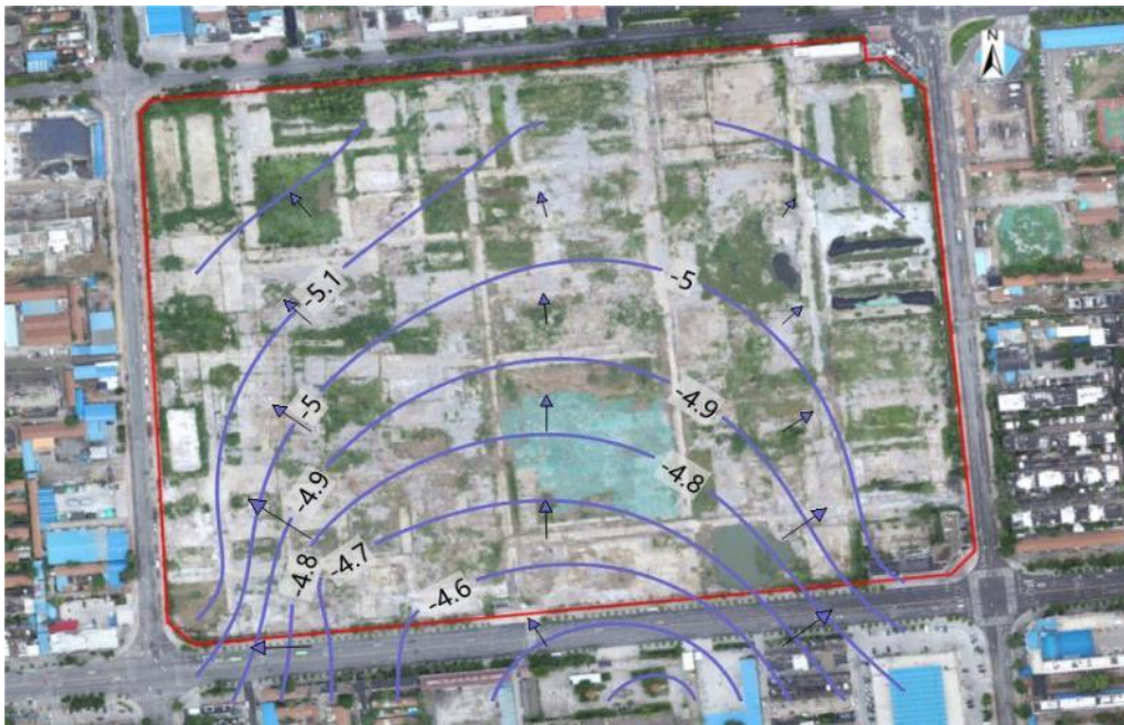
图 3-16 场区潜水-微承压流场等值线图
