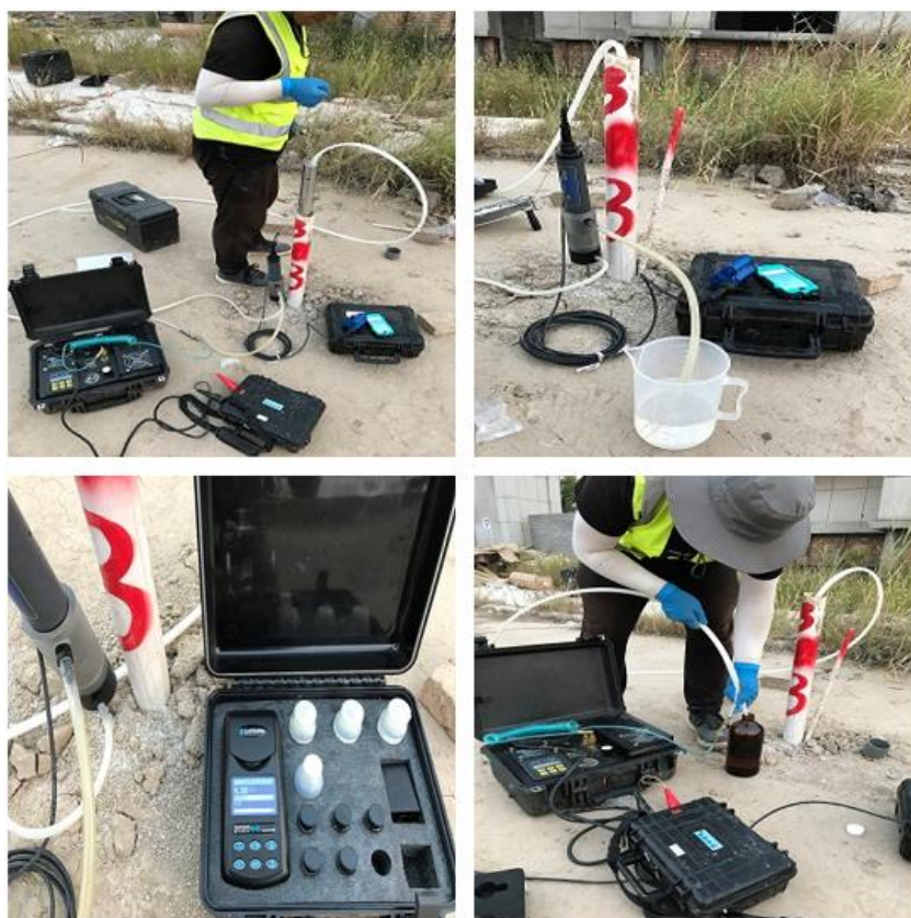
图 6-12 采样前气囊泵洗井
