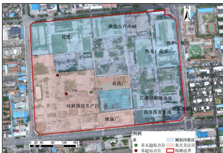
图 5-14 第六层（26.0~33.0m）苯超标点位示意图
