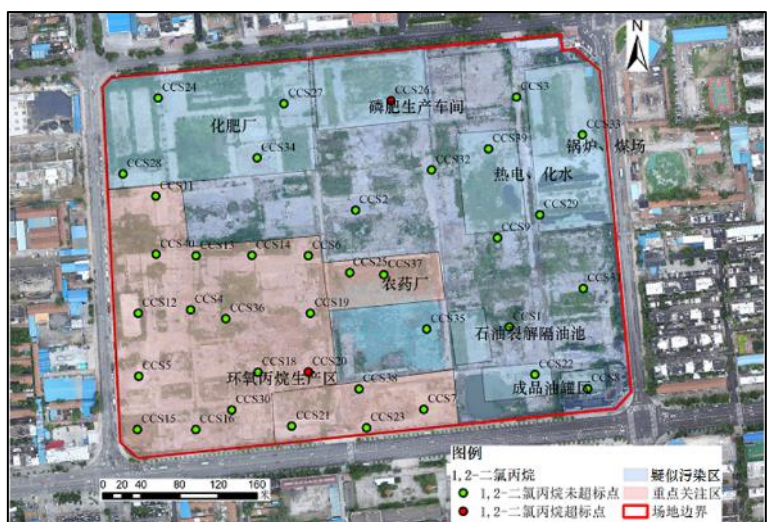
图 5-15 第一层（0~1.6m）1,2-二氯丙烷超标点位示意图
