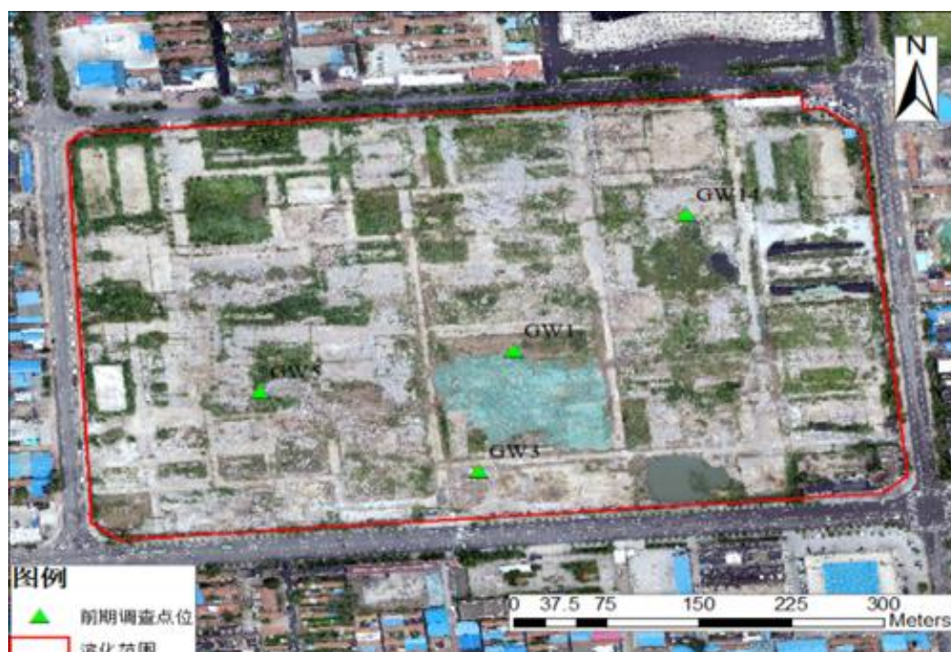
图 4-10 老厂区前期调查阶段的采样点位分布图
