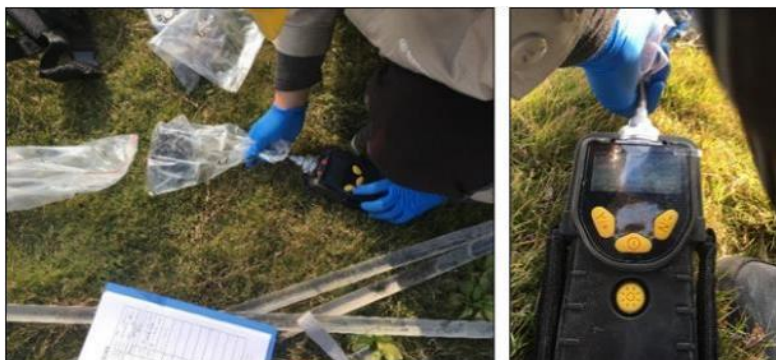
图 6-14 现场 PID 快速检测
