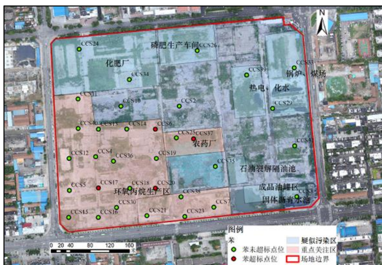
图 5-11 第三层（8.3~16.7m）苯超标点位示意图
