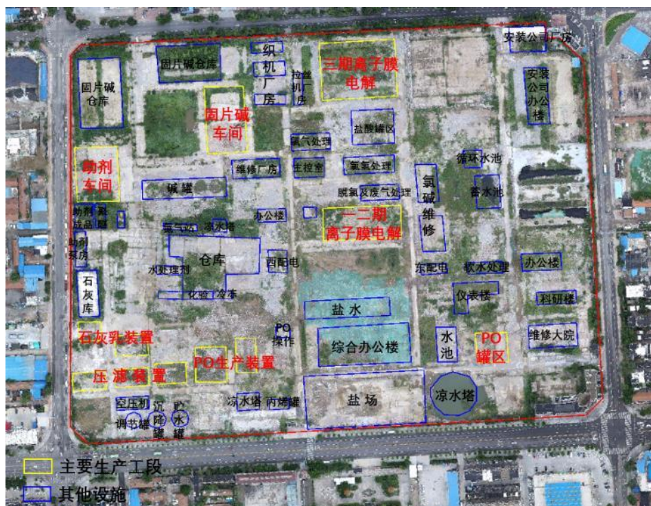
图 4-3 老厂区关停前不同生产车间平面布置图
