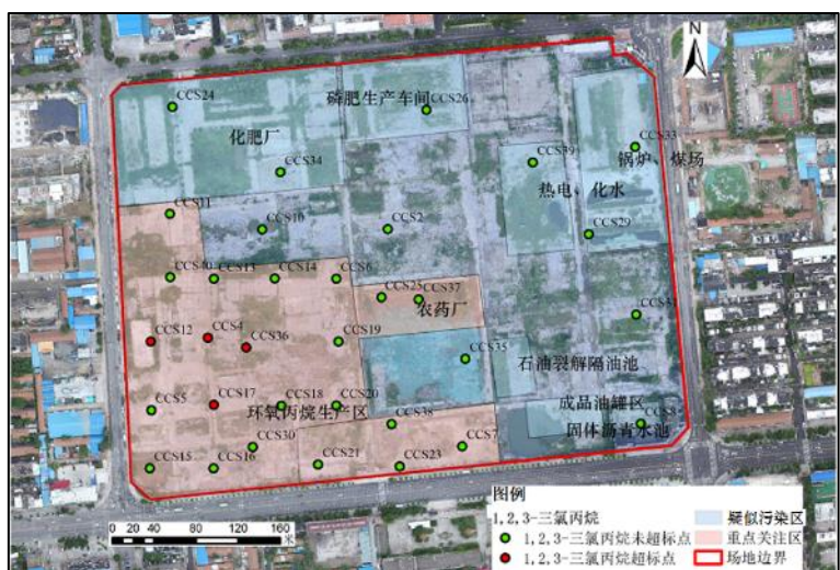
图 5-25 第三层 (8.3~16.7m) 1,2,3-三氯丙烷超标点位示意图
