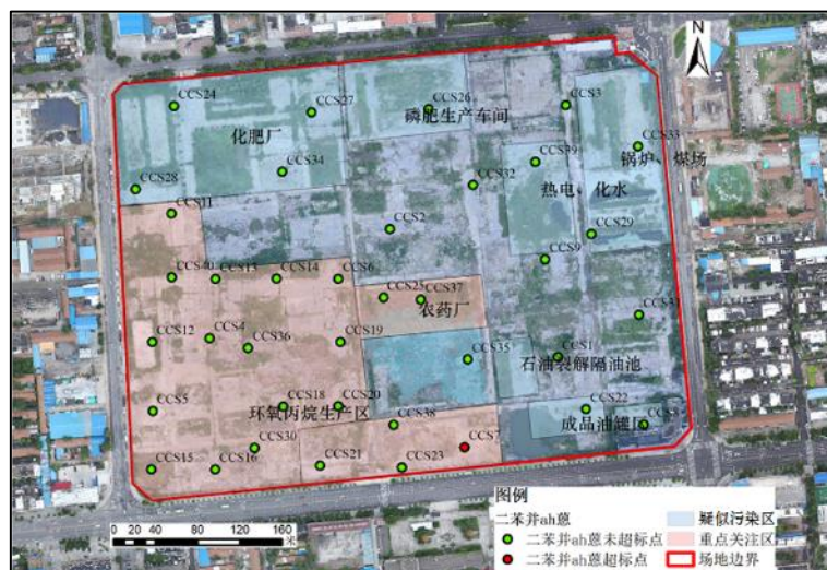
图 5-36 第一层（0~1.6m）二苯并(a,h)蒽超标点位示意图
