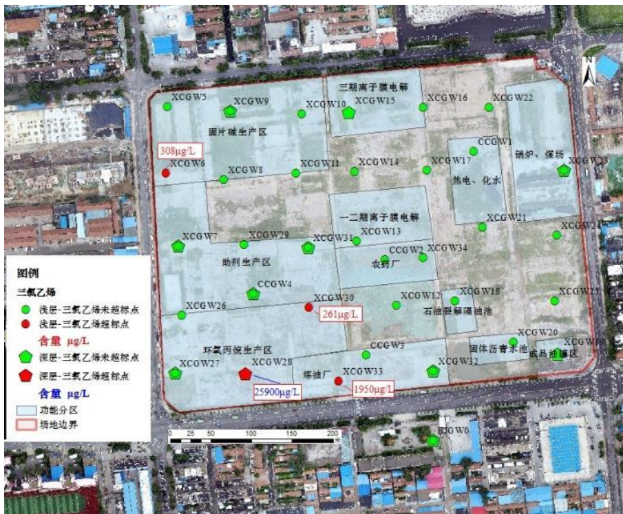
图 7-139 地下水中三氯乙烯污染分布
