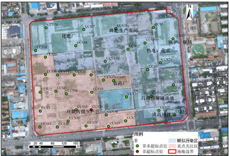
图 5-35 第一层（0~1.6m）菲超标点位示意图
