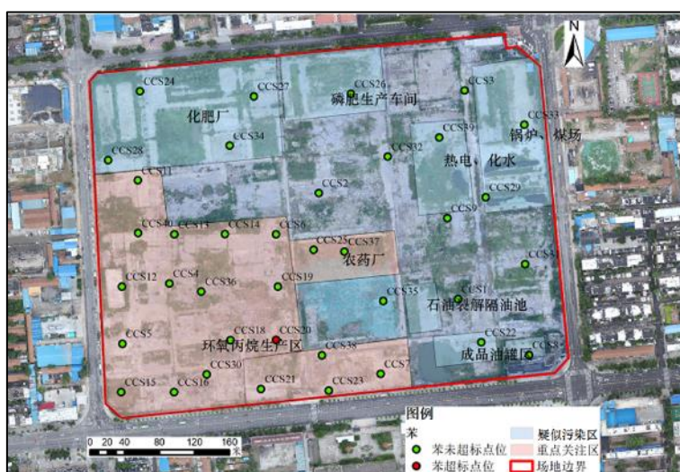
图 5-9 第一层（0~1.6m）苯超标点位示意图
