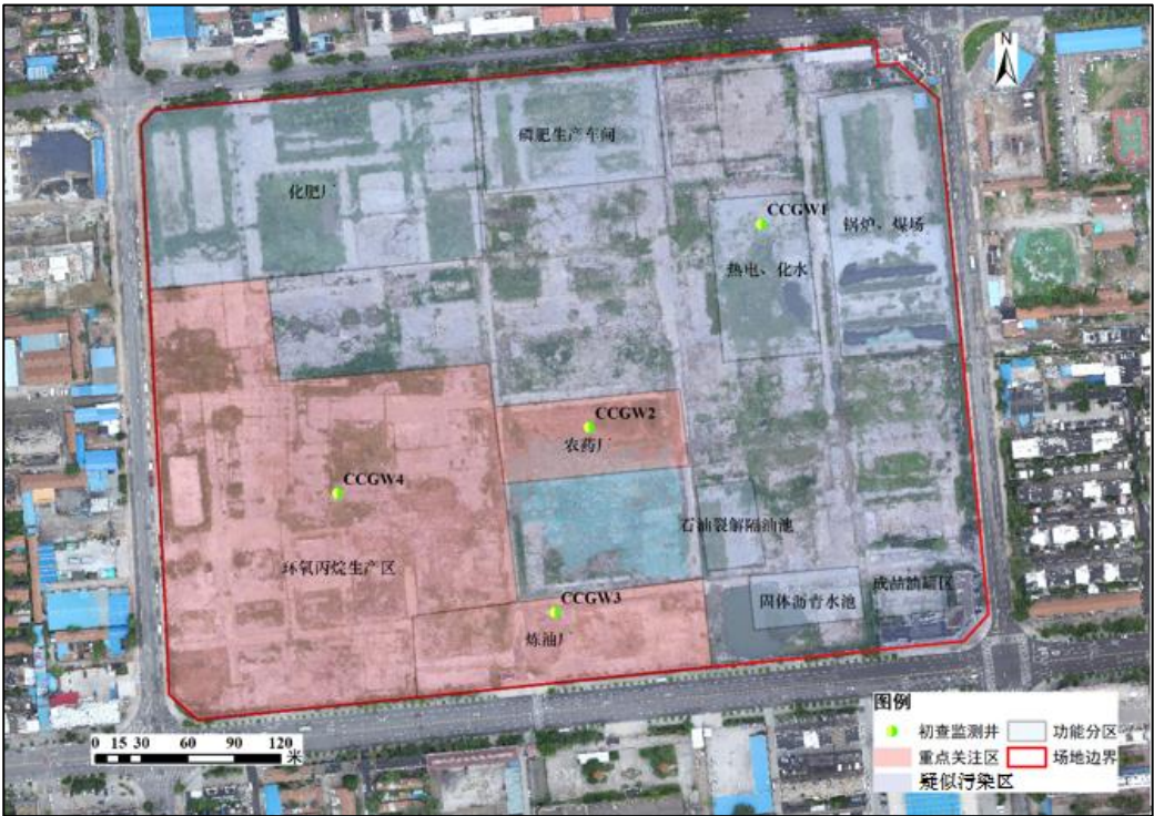
图 5-41 初步调查阶段监测井实际布设点位图
