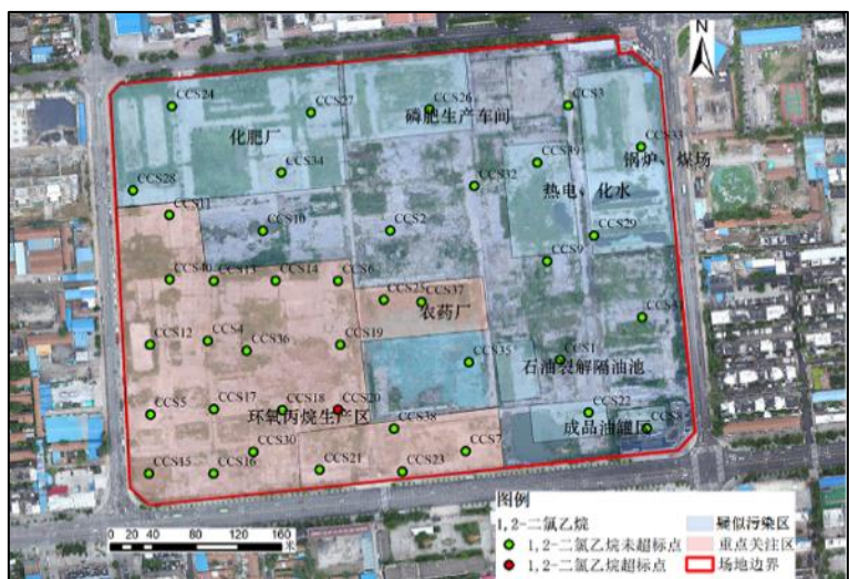
图 5-29 第二层（1.6~8.3m）1,2-二氯乙烷超标点位示意图
