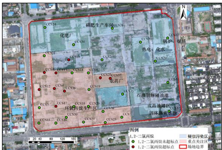
图 5-17 第三层（8.3~16.7m）1,2-二氯丙烷超标点位示意图
