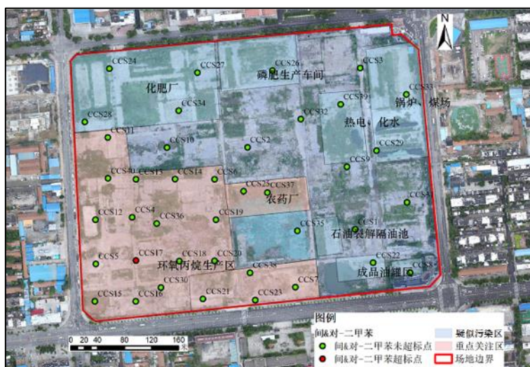
图 5-7 第二层 (1.6~8.3m) 间&对-二甲苯超标点位示意图
