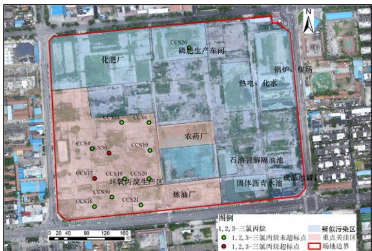
图 5-26 第四层 (16.7~20.6m) 1,2,3-三氯丙烷超标点位示意图
