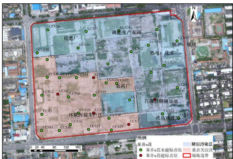
图 5-38 第一层（0~1.6m）苯并(a)芘超标点位示意图
