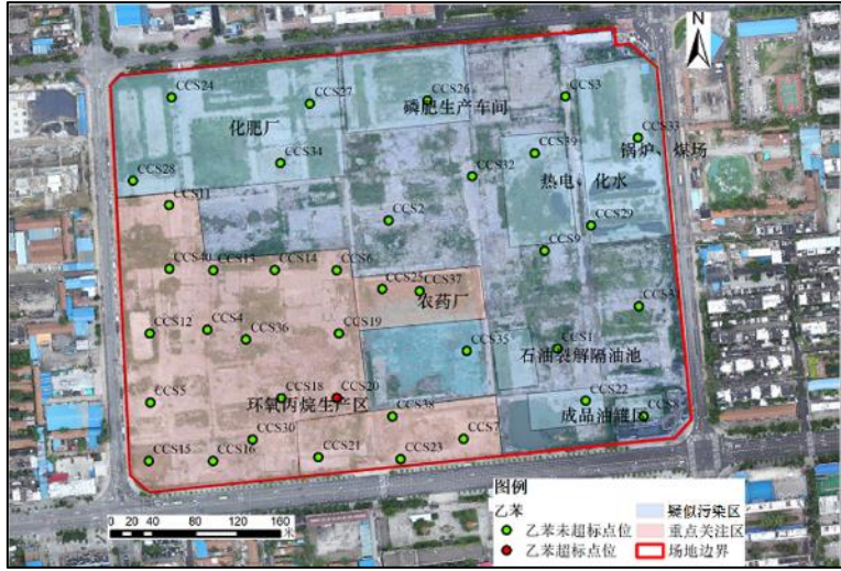
图 5-21 第一层（0~1.6m）乙苯超标点位示意图
